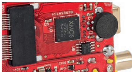
Jako interfejs wejściowy USB, producent stosuje świetny scalak XMOS.
