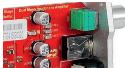
Sekcja analogowa ma wydzielone, dedykowane układy dla wyjścia słuchawkowego.
